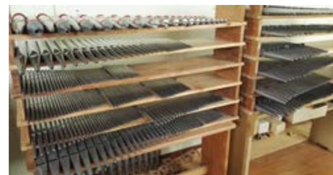
Alle de 2000 pipene blir satt ned i dette spillebordet (til venstre) og forhåndsintonert på fabrikken. Når orgelet er bygget ferdig i Vardåsen kirke brukes det tre uker på å intonere dem en gang til slik at de passer til kirkerommet.
