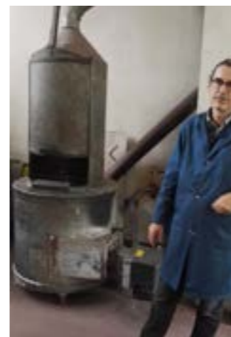
Bly og tinn smeltes ved 400 grader i denne ovnen.
