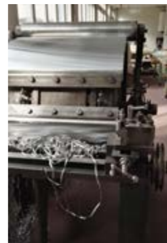
Bly/tinnplaten blir valset til store plater og formes til piper
