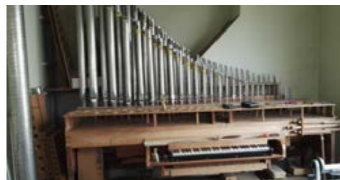
Alle de 2000 pipene blir satt ned i dette spillebordet (til venstre) og forhåndsintonert på fabrikken. Når orgelet er bygget ferdig i Vardåsen kirke brukes det tre uker på å intonere dem en gang til slik at de passer til kirkerommet.
