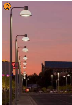
Referansebilde: Opal skjerm som gløder. Godt avskjermnet med asymmetrisk optikk.
