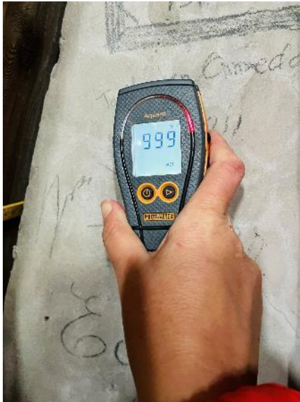
Bilde 47, Fullt utslag på fuktindikator på pusset innside av tårn
