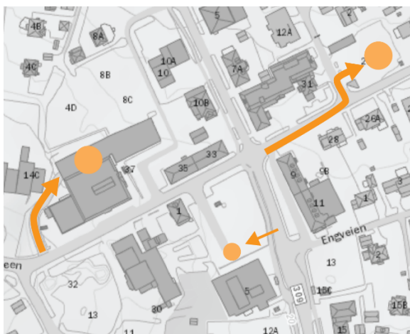
Trafikkstrømmer til parkeringsanlegg med noe overflateparkering på torvet og parkering i Teiegården.
