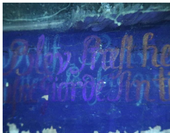
Figur 65. Detalj av skriffelt i UV viste en eldre skrift under den sekundære gullmalingen som ikke er synlig i ordinær belysning.
