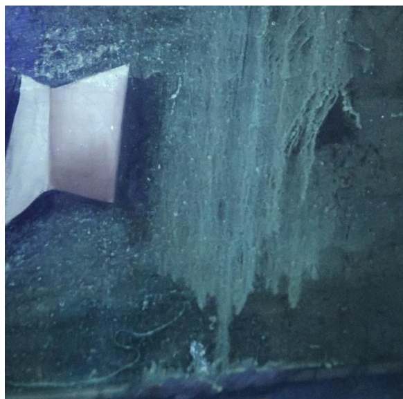
Figur 67. Detalj av ujevn og rennende ferniss som fluorescerer grønnlig i UV.
